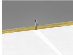
Corte do sistema Advantage A com Connect T24
